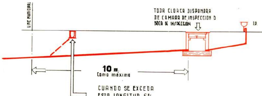
TOCA CADA CADA UNO DE LOS CAMBIOS DE DIRECCION DE LA CAÑERIA DEBE DISPONERSE DE UNA BOCA DE INSPECCION O CAMARA DE INSPECCION
